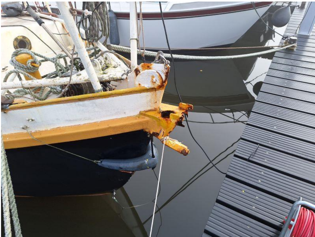
De door dwarskracht op het anker afgescheurde koker.
