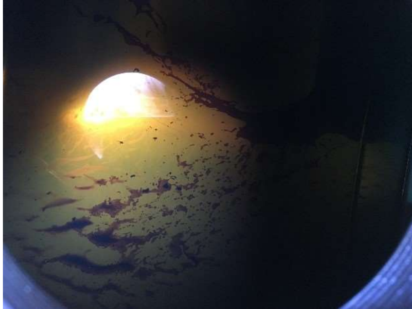
Figuur 4: Aangroei op de bodem van de dieseltank vóór toevoegen van Grotamar 81
