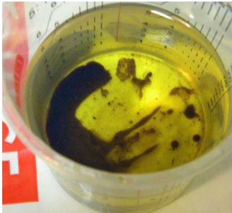
Figuur 2: Het bezinksel uit het groffilter
