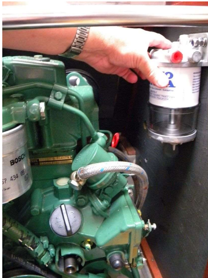
Figuur 1: Hier moest het groffilter maar komen; links is nog een stukje van het fijnfilter te zien met opschrift "BOSCH".
