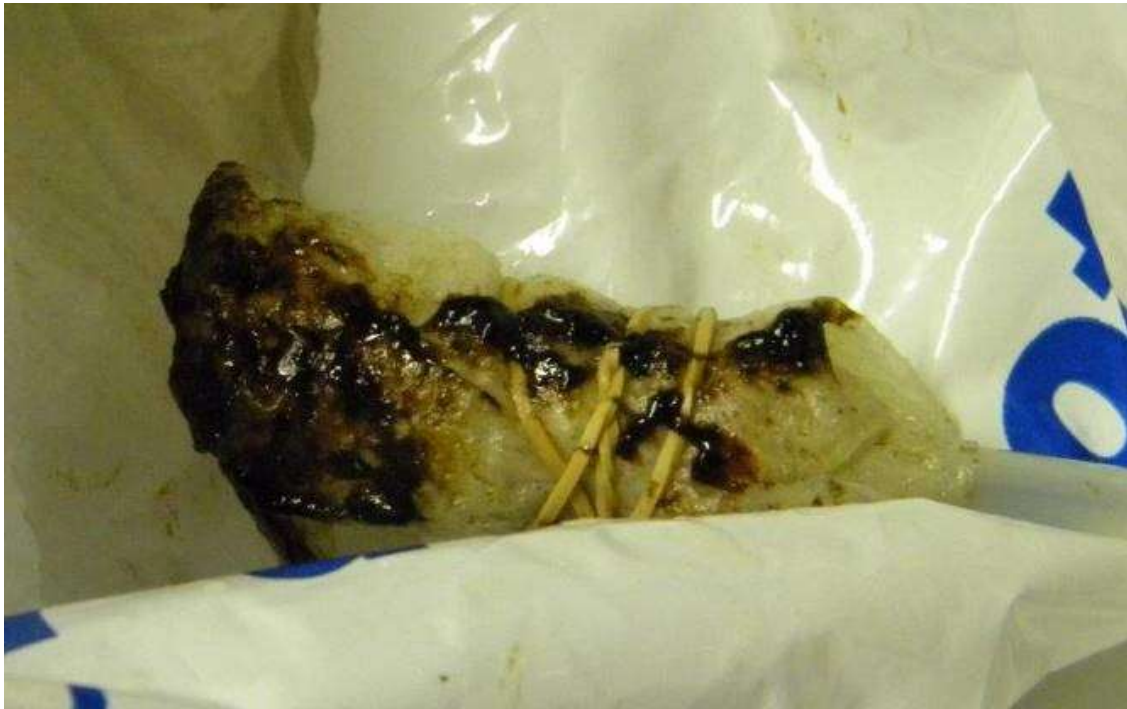
Figuur 3: De drab of 'sludge' uit de tank op een keukenpapiertje
