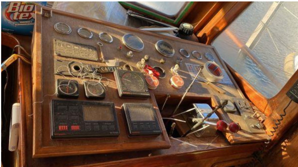
Dashboard, met twee bedieningshandels voor de rechtermotor; die van de linker zijn al verwijderd.
