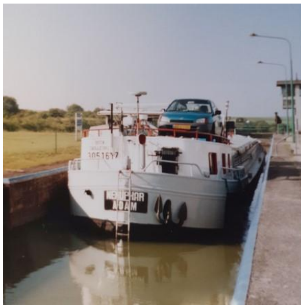
foto links: Canal du Nord: sluisen van 6m breed en 91m lang; foto rechts: op de Seine tussen Les Andelys en Rouen (2004).
